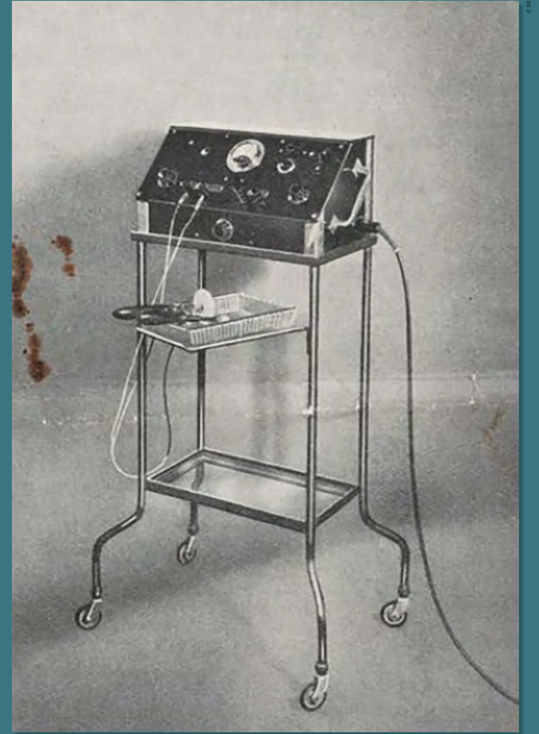
8 Modèle d'appareil d'électrochocs moderne commandé par le professeur Bostroem pour la clinique psychiatrique.
